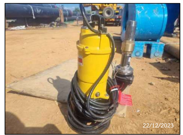
รูปที่ 2-26 เครื่องสูบน้ำแรงดันต่ำสำรองประจำพื้นที่ก่อสร้าง
