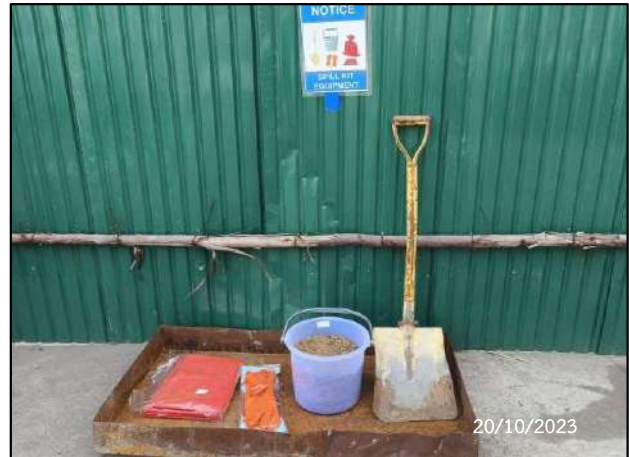
รูปที่ 2-23 จัดเตรียมภาชนะรองรับป้องกันการหกรั่วไหลของน้ำมันและสารเคมี พร้อมทั้งวัสดุดูดซับ
